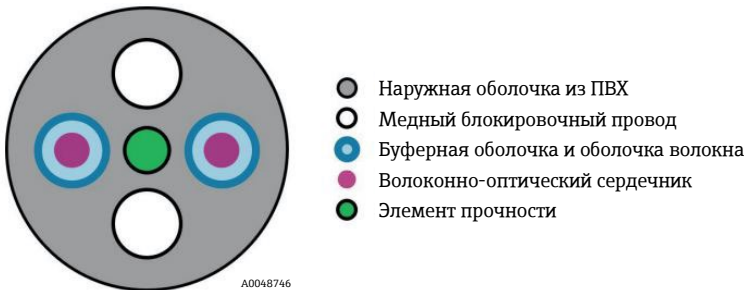
Рисунок 8. Представление оптоволоконного кабеля Raman в разрезе
