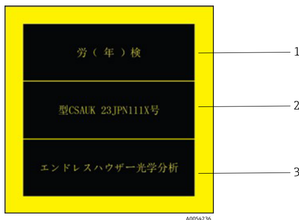
Figura 8. Etiqueta JPEX para uso em áreas classificadas
