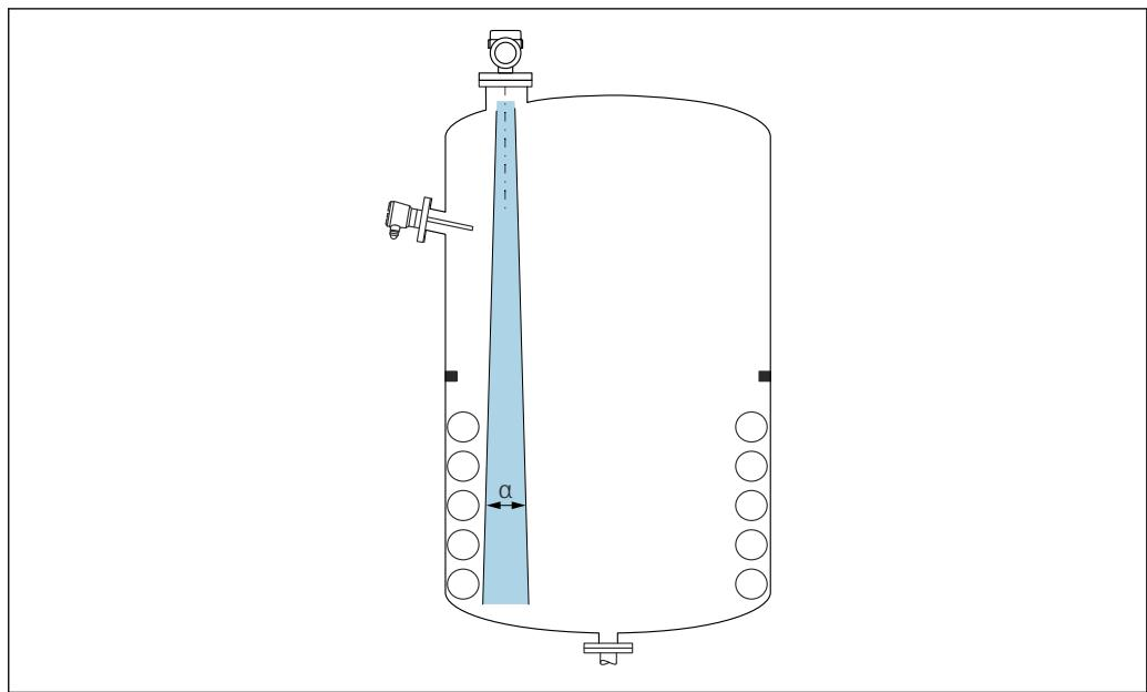
Evite acessórios internos (chaves de nível, sensores de temperatura, suportes, anéis de vácuo, bobinas de aquecimento, deflectores etc.) dentro do feixe de sinal. Preste atenção ao ângulo do feixe  $\alpha$ .
