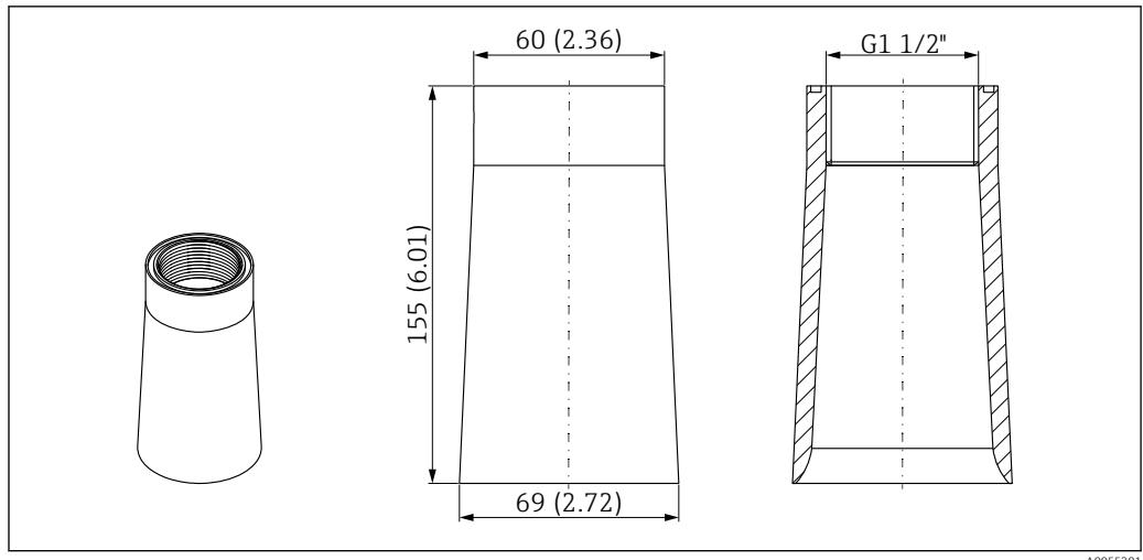
Fig. 25 Dimensões do tubo de proteção contra transbordamento 40 mm (1.5 in). Unidade de medida mm (in)
