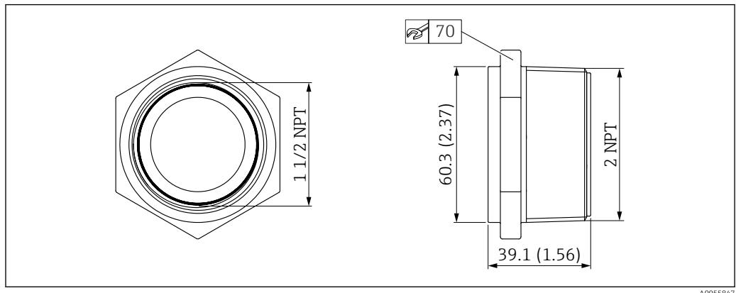
Fig. 24 Dimensões do adaptador Uni
