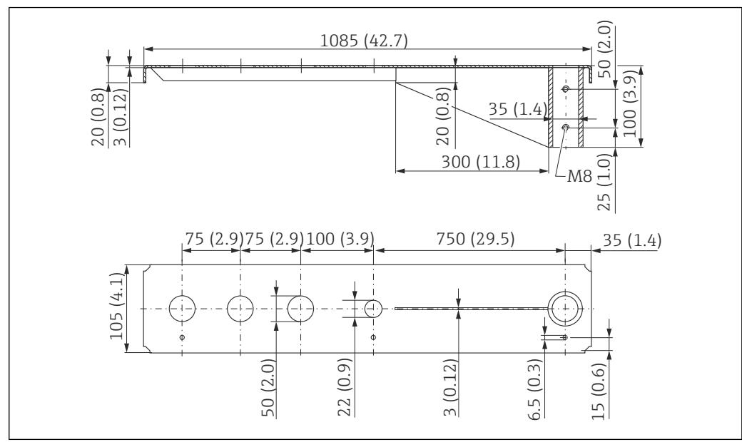
36 Dimensões do braço articulado 1 000 mm com pivô, para conexão de processo na extremidade da antena do sensor G 1½". Unidade de medida mm (in)
