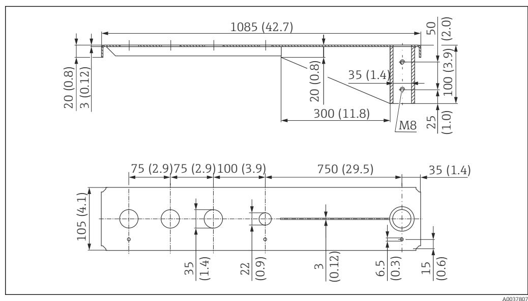
33 Dimensões da escora 1000 mm com pivô para conexão de processo na entrada para cabo do sensor.
