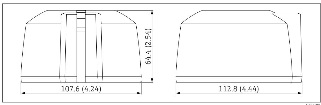
20 Dimensões da tampa de proteção contra o tempo G1/NPT1, entrada para cabos por cima. Unidade de medida mm (in)
