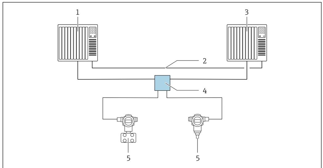
11 Beispiel für den Aufbau eines redundanten Systems (S2): Stern-Topologie
