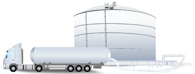
図1: ピークシェービングプラントにおけるLNGトラック積載
