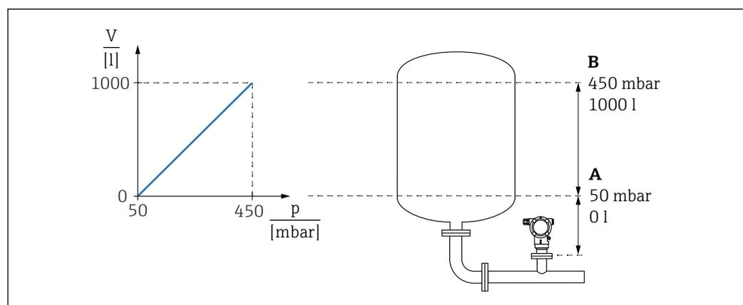
A Parameter "Druckwert 1" und Parameter "Skalierte Variable Wert 1"
