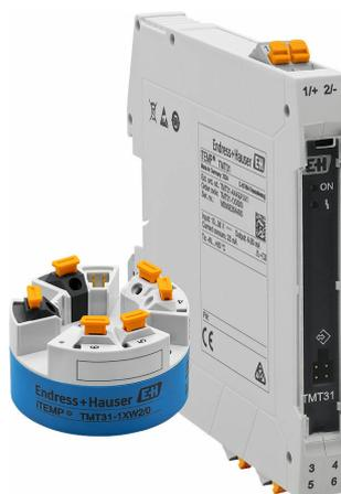
Transmisor de temperatura de 4-20 mA en forma de cabezal o equipo de raíl DIN con una entrada de sensor RTD o TC adecuado para el uso en áreas de Zona 2 (Ex ec)/Div. 2
