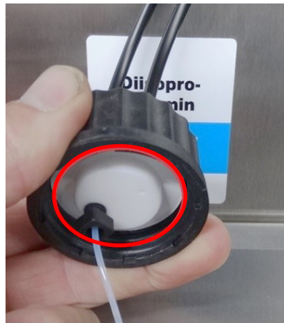
O-Ring für Alkalisierungseinheit oder für Überströmventil/Druckbegrenzer Probenkonditionier. (außen)
