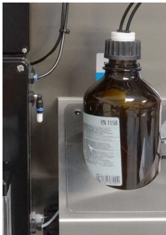
Dichtung für Flaschenanschluss der Alkalisierungsreagenz-Flaschen
