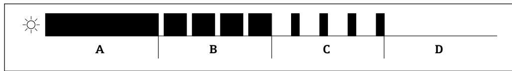
3 Графическое изображение различных состояний мигания светодиодных индикаторов при выборе функции
