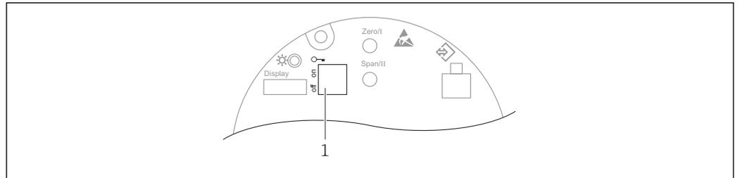
1 Minisseletores para bloqueio e desbloqueio do medidor
