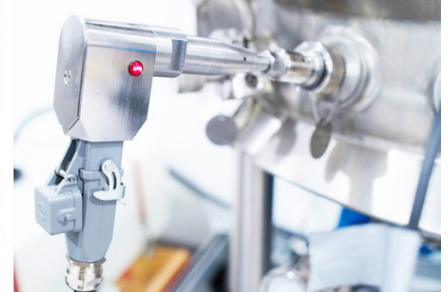
図1: バイオプロセス条件のために最適化されたリアルタイムの in situ プローブにより、分析モデルの移設が容易になり、ラボ (左) と製造現場 (右) での測定が実現します。
