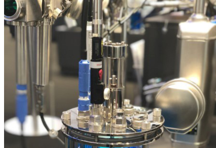
図1: バイオプロセス条件のために最適化されたリアルタイムの in situ プローブにより、分析モデルの移設が容易になり、ラボ (左) と製造現場 (右) での測定が実現します。
