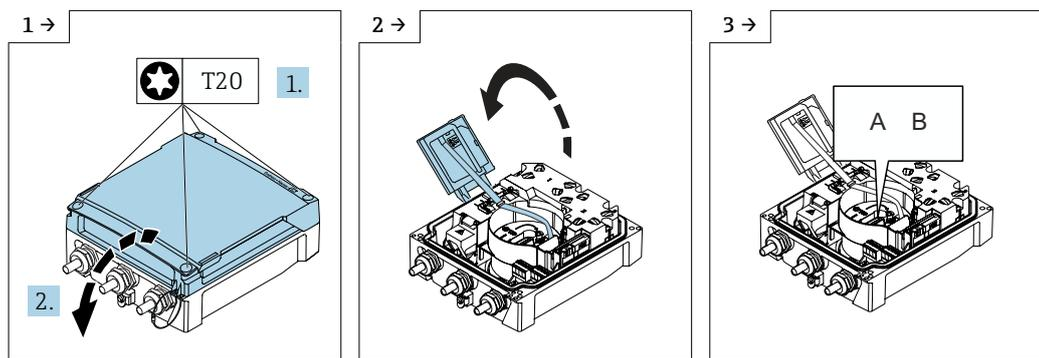
▶ Откройте крышку клеммного отсека.
