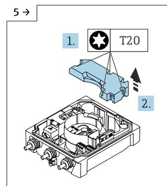
▶ Снимите крышку пакета элементов питания.
