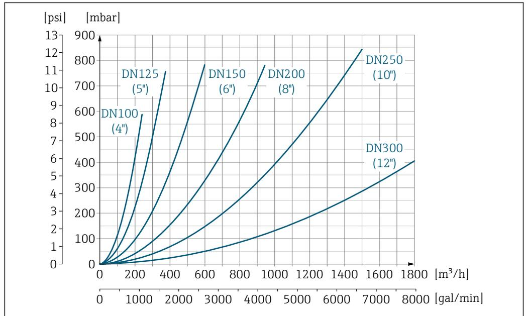
19 Падение давления для DN 100–300 (4–12 дюймов) с кодом заказа «Конструкция», опция С «Фиксированный фланец, суженная измерительная трубка, без входных/выходных участков»
