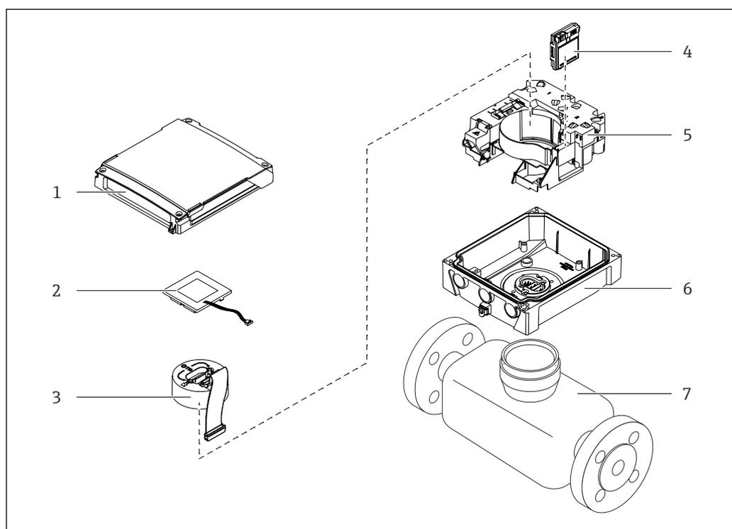
2 Важные компоненты прибора в компактном исполнении
