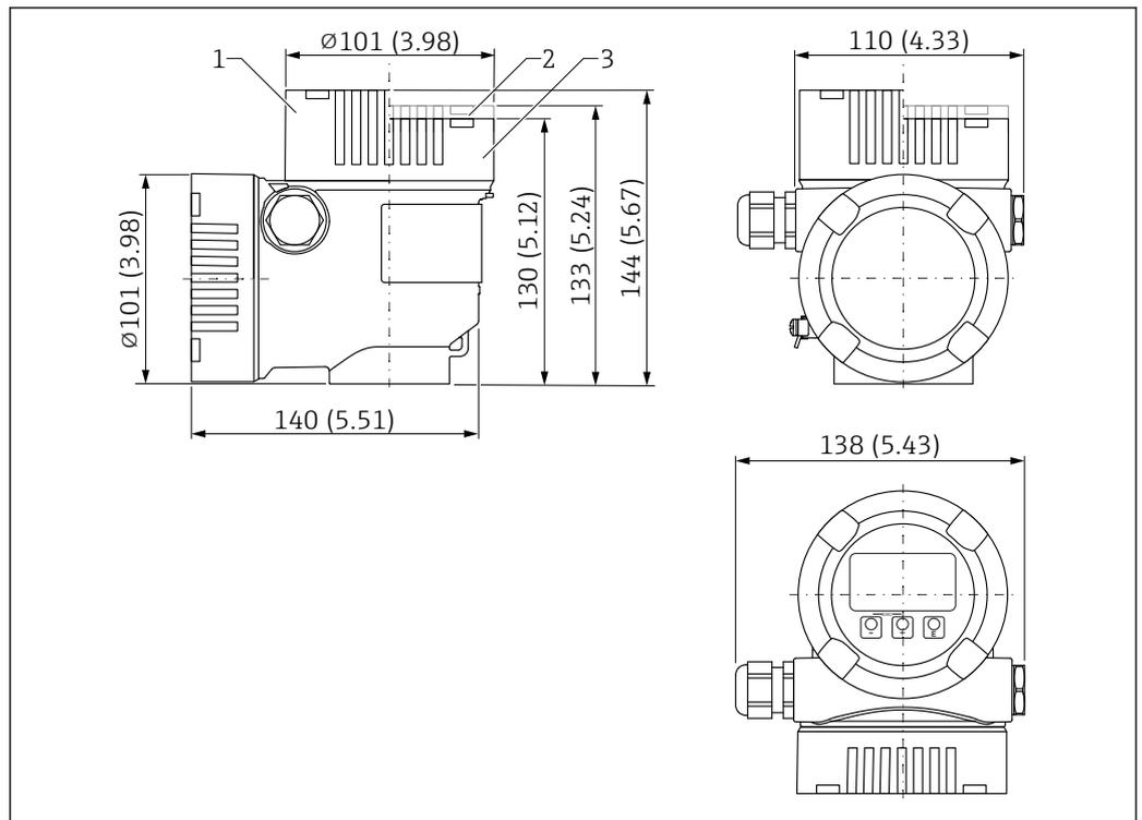
28 Dimensions ; boîtier à double compartiment en L, 316L ; avec raccord M20 et bouchon, plastique. Unité de mesure mm (in)
