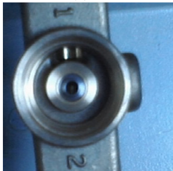
Рисунок 67 Седло клапана / уплотняющая поверхность в магнитном клапане
