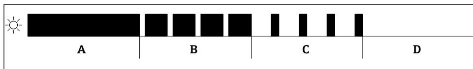
4 Графическое отображение различных состояний мигания светодиодных индикаторов при выборе функции
