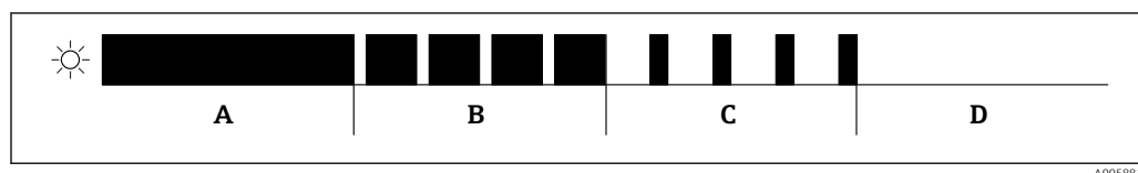
17 Visualizzazione grafica dei diversi stati di lampeggio del LED quando si seleziona una funzione
