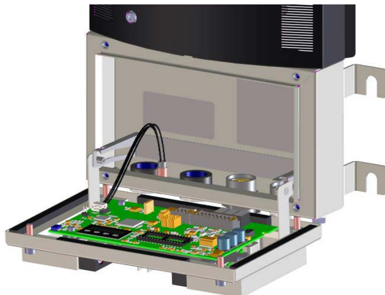
Fig. 23: Ranura para el cable del LED de estado
