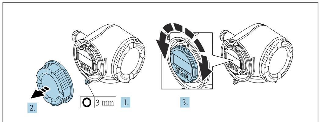
1. 機器バージョンに応じて、端子部カバーの固定クランプを緩めます。
