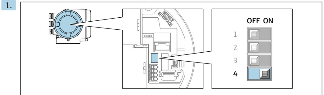
1. メイン電子モジュールの書き込み保護スイッチ（SIM）を **ON** の位置（工場設定）に設定します。
