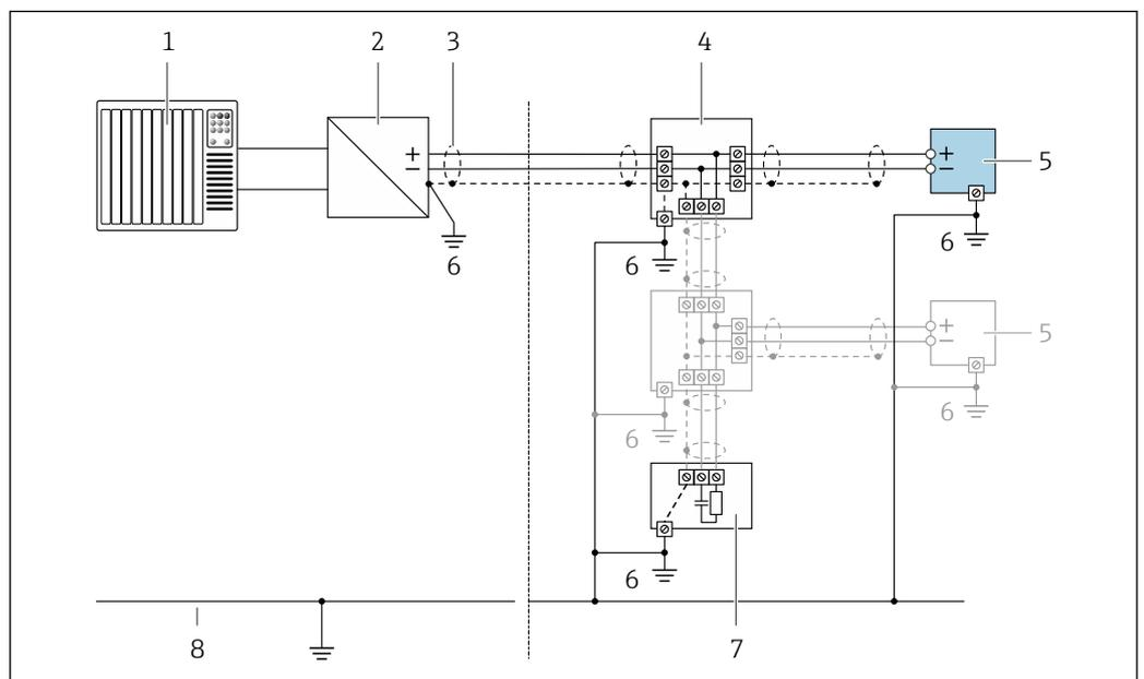
図 10 FOUNDATION フィールドバスの接続例
