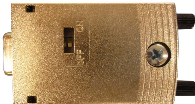
Fig. 10 : connecteur avec interrupteur de résistance de terminaison
