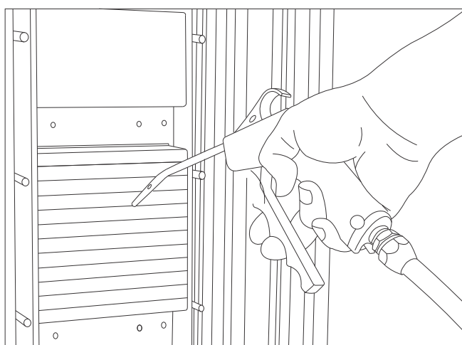
Рисунок 46. Очистка радиаторов с помощью сжатого воздуха или воды
