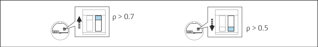
图 46 电子插件上的密度设置开关
