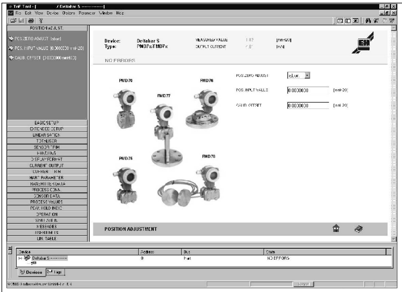
Kuva 33. ToF Tool -käyttöohjelmisto, jossa asetukset määritetään valikoiden kautta
