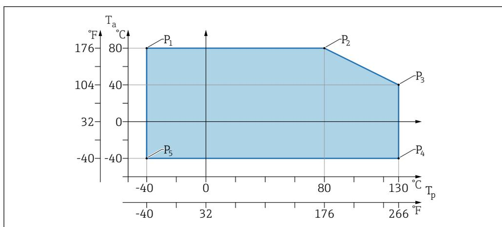
12 Temperatura ambiente T<sub>a</sub> in base alla temperatura di processo T<sub>p</sub>
