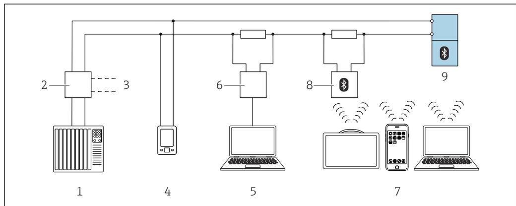
**8** Opzioni per funzionamento a distanza mediante protocollo HART
