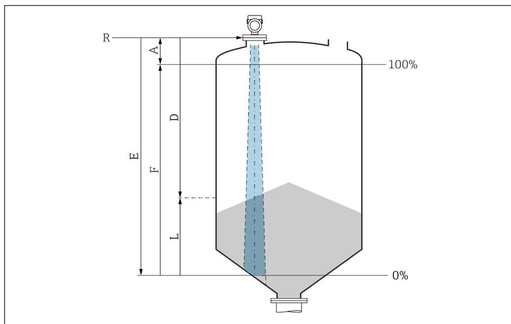
10 Parametri di configurazione per la misura di livello nei solidi sfusi
