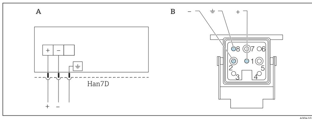
A Электрическое подключение для приборов с разъемом Harting Han7D
