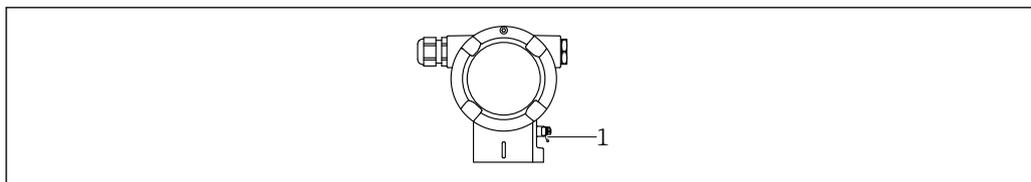
1 Клемма заземления для подключения линии выравнивания потенциалов
