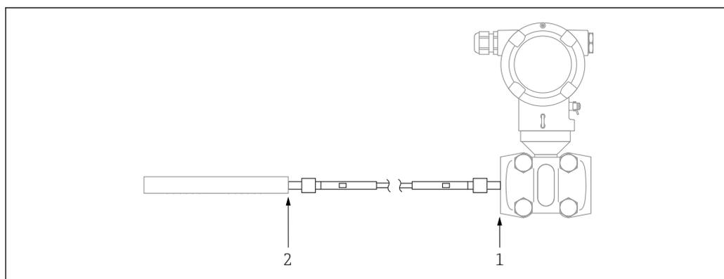
6 Длина капиллярной трубки представляет собой расстояние между овальным фланцем и задней стороной разделительной диафрагмы. Единица измерения мм (дюйм)
