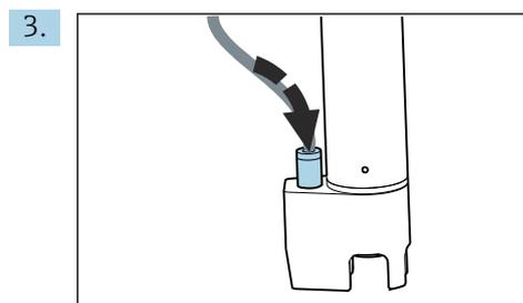
Conecte la manguera de suministro de aire comprimido (se debe proporcionar en planta) o el compresor (→ 32) a la conexión de manguera de la unidad de limpieza.
