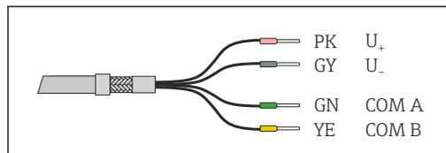
Fig. 12 Cable fijo del sensor con conductores de cable terminados
