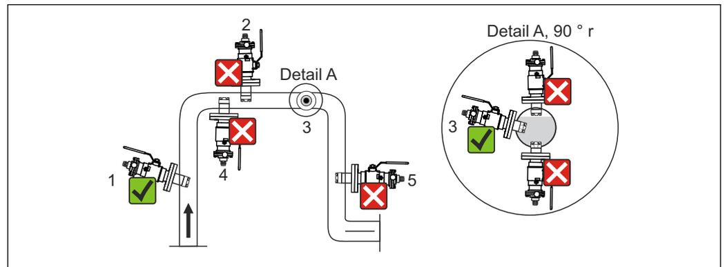
11 Posiciones de instalación del sensor admisibles y no admisibles con el portasondas retráctil COA451
