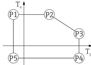
32 Gehäuse 316L, Hygiene; Prozesstemperatur  $-40 \dots +80 \text{ °C}$  ( $-40 \dots +176 \text{ °F}$ )
