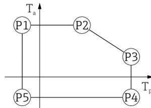
33 Gehäuse 316L, Hygiene; Prozesstemperatur  $-40 \dots +130 \text{ °C}$  ( $-40 \dots +266 \text{ °F}$ )
