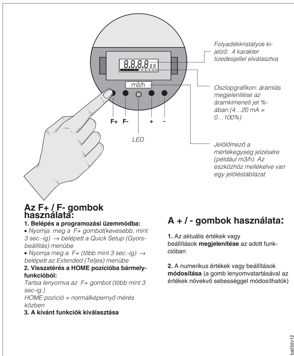
Fig. 19 A Prowirl 77 kijelzője és vezérlőelemei
