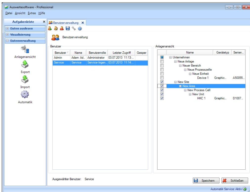
Durch Markieren des Benutzers in der Liste kann diesem ein definierter Zugriff auf einzelne Geräte und Anlagenteile gegeben werden. Der Administrator markiert hierbei einen Knotenpunkt. Somit hat der Benutzer Zugriff zum entsprechenden Knotenpunkt (z. B. Anlage, Bereich, ...) sowie zu allen zugeordneten Unterknoten.
