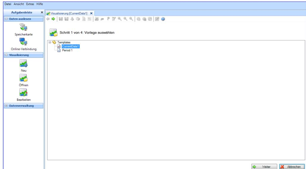
Wurde eine Vorlage gewählt, erscheint der Button „Weiter“. Bei einer Vorlage für gespeicherte Daten wird über diesen in Schritt 3 gesprungen. Bei einer Vorlage für aktuelle Daten beginnt sofort die Messwertanzeige.
