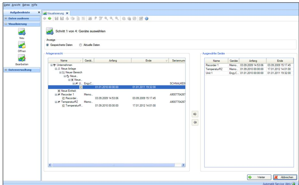
Durch Markieren eines Geräts in der Anlagenansicht und Doppelklick oder Klick auf den blau erscheinenden Pfeil nach rechts wird ein Gerät für die Visualisierung ausgewählt.
