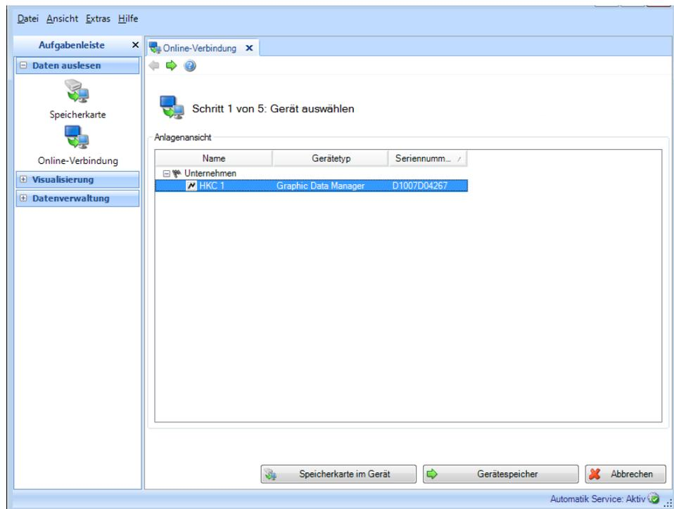
Über die Buttons "Speicherkarte im Gerät" und "Gerätespeicher" werden die auszulesenden Daten des Geräts gewählt.
