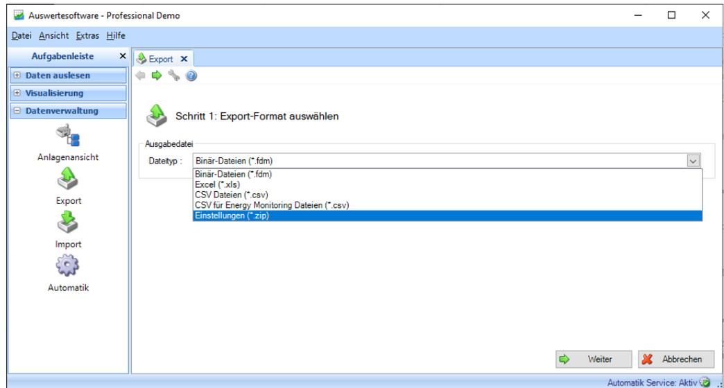
Durch Betätigen des Buttons „Weiter“ oder des grünen Pfeils in der Symbolleiste wird in den nächsten Schritt gesprungen.
