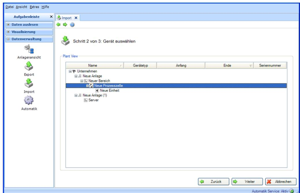
Durch Betätigen des Buttons „Weiter“ oder des grünen Pfeils in der Symbolleiste wird in den nächsten Schritt gesprungen und der Import gestartet.
