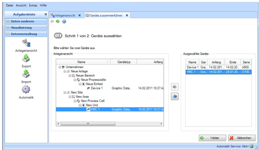
Durch Betätigen des Buttons „Weiter“ oder des grünen Pfeils in der Symbolleiste wird in den Schritt 2 gesprungen und die Daten der Geräte zusammengeführt.
