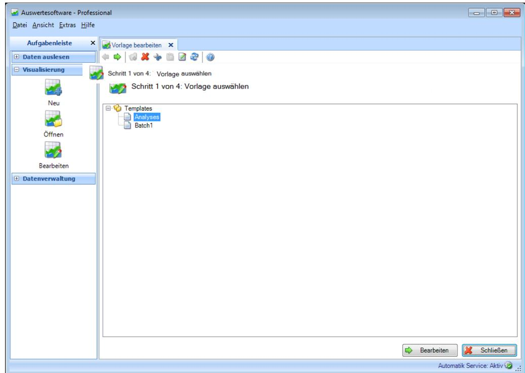
Durch Markieren einer Vorlage und Betätigen der rechten Maustaste kann die gewählte Vorlage gelöscht oder umbenannt werden.
