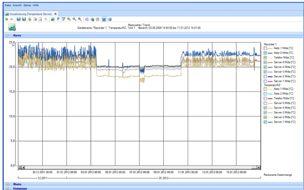
Der Hinweis „Reduzierte Datenmenge“ bedeutet, dass die Daten zur Aufbereitung des Diagramms automatisch reduziert wurden. Dies ermöglicht eine schnelle Darstellung. Beim (mehrfachen) Zoom in das Diagramm erlischt dieser Hinweis, da sämtliche Werte zur Darstellung herangezogen werden müssen.
