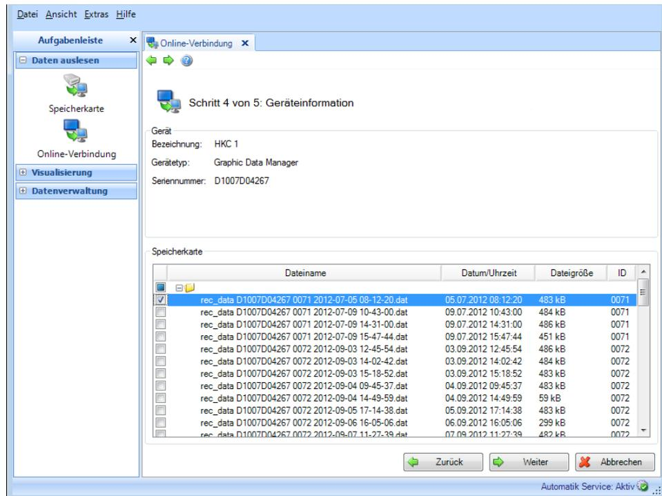
Um das ausgewählte Gerät bzw. die Kommunikationsspezifikationen zu ändern, kann über „Zurück“ auf die vorherigen Schritte zurückgesprungen werden.
