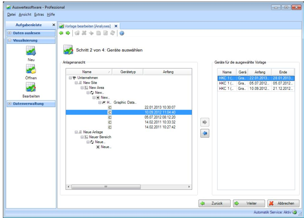
Durch Markieren eines Geräts in der Anlagenansicht und Doppelklick oder Klick auf den blau erscheinenden Pfeil nach rechts wird ein Gerät für die Visualisierung ausgewählt.
