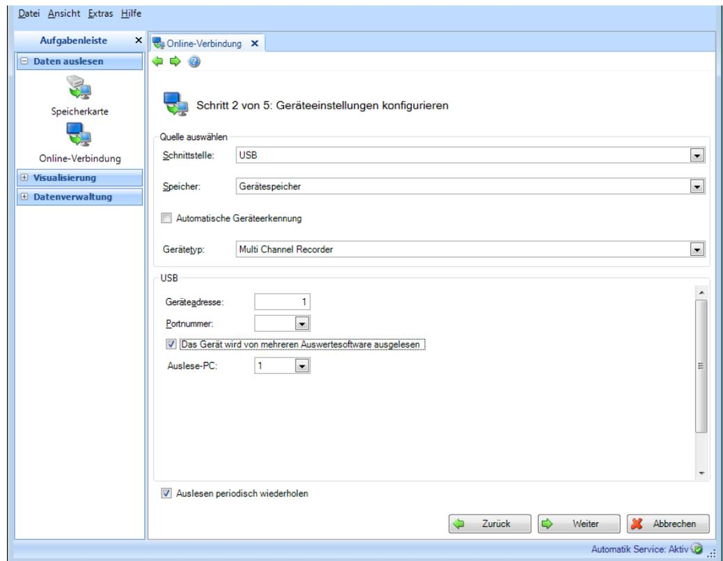
Das Markieren des Kästchens „Das Gerät wird von mehreren Auswertesoftware ausgelesen“ ermöglicht ein Auslesen von mehreren (max. 4) PCs.
