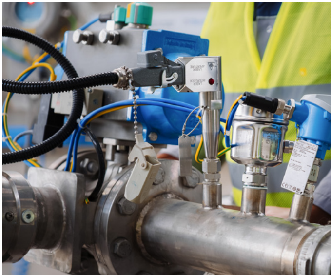
Von links nach rechts: Endress+Hauser Raman-Rxn-40-Sonde, Grenzstandschalter Liquiphant FTL50 und Thermometer iTHERM ModuLine TM131
