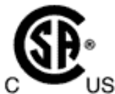
Рис. 5. Маркировка CSA для использования во взрывоопасных зонах в США и Канаде
