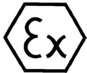
Рис. 4. Ярлык АTEX для использования во взрывоопасных зонах
