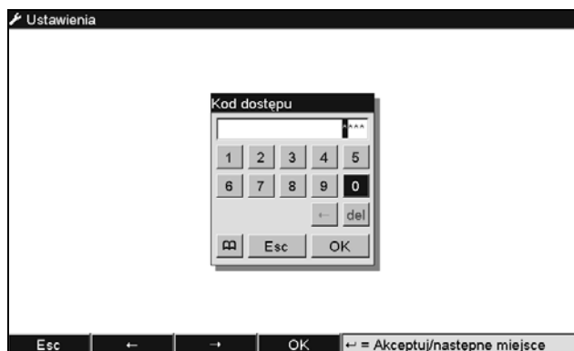
Rys. 23: Wprowadzanie kodu dostępu dla ustawienia Ekspert (ustawienie fabryczne: 0000)
