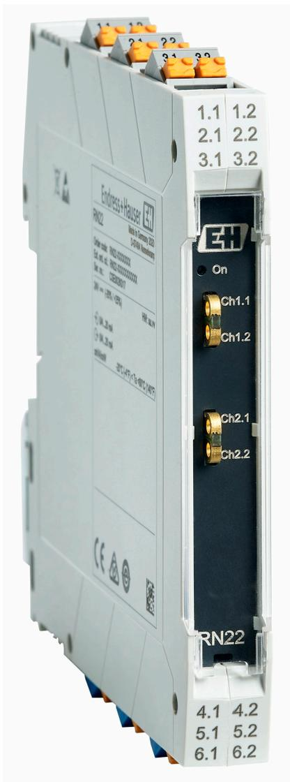
单通道型/双通道型有源安全栅/隔离器，用于安全隔离 4...20 信号回路，支持 HART®数据透明传输，24 V<sub>DC</sub> 供电电压，带有源/无源输入和输出，可选 SIL 认证和防爆认证
