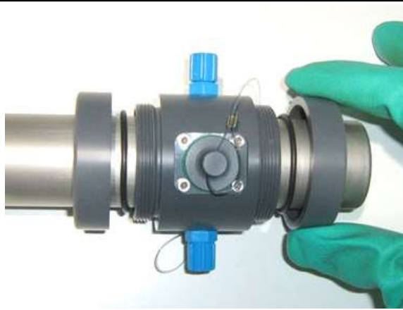
Abbildung 5 Erst O-Ring, dann Schraubring auf den Sensor schieben
