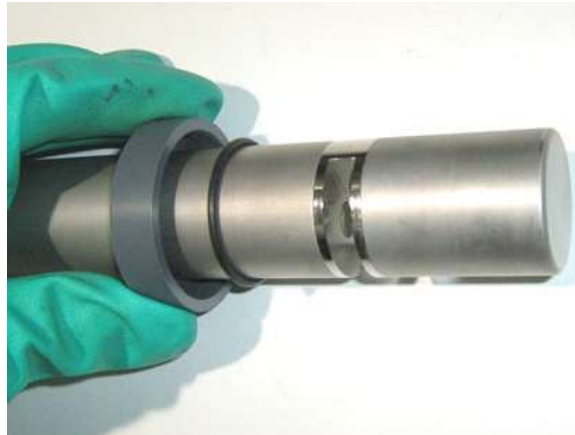
Abbildung 3 Erst einen Schraubring, dann O-Ring, auf den Sensor schieben
