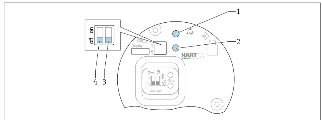
40 Teclas de configuración y microinterruptor en el módulo del sistema electrónico FEL60H
