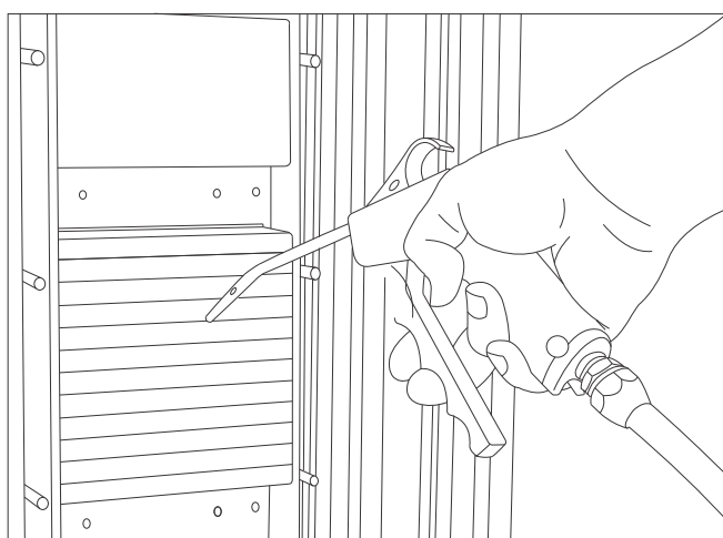
Figura 46. Limpeza dos dissipadores de calor com ar comprimido ou água
