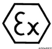
図 3. 危険場所での使用するための ATEX ラベル
