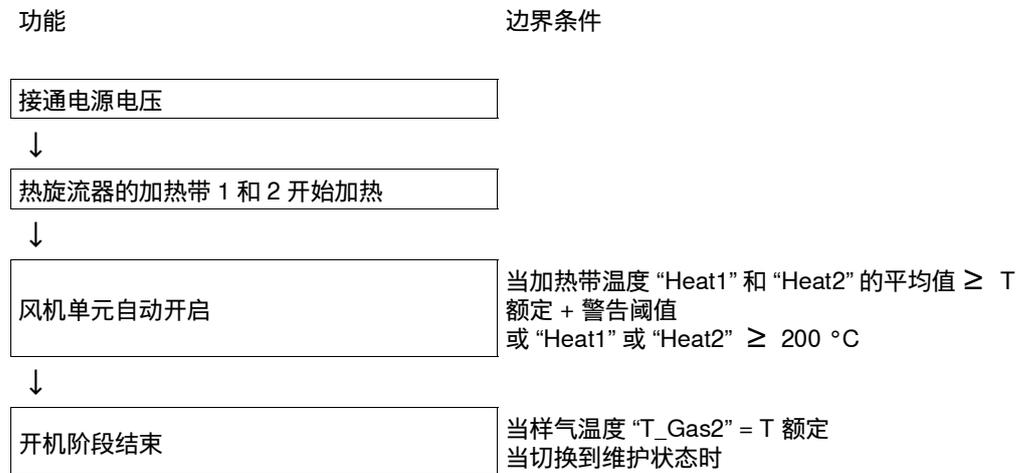
在控制单元的液晶显示屏上将显示当前测量值（参见“液晶显示屏，带有图形（左）和文字显示（中和右）（示例）”，第 24 页，参见“使用 SOPAS ET 改动显示屏设定”，第 83 页）。这时，使用“Initialization（初始化）”来代替“Operation（操作）”表示开机阶段。
