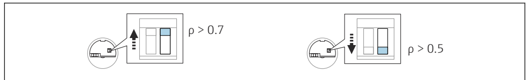
57 Posizione di commutazione per densità sull'inserito elettronico
