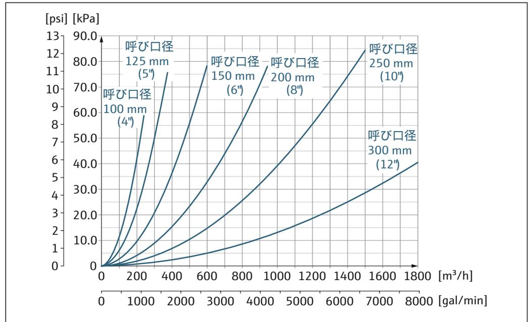
図 23 圧力損失 呼び口径 100 ~ 300 mm (4 ~ 12")、「設計」のオーダーコード、オプション C「面間寸法ショート、300 mm まで ISO/DVGW、上流側/下流側直管長なし、縮小計測チューブ」の場合
