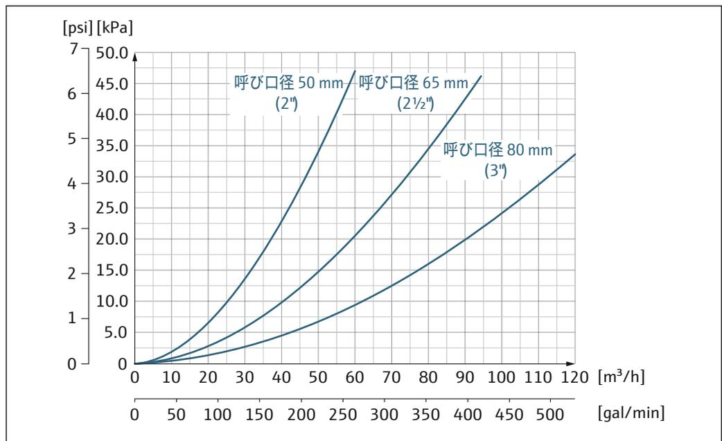
図 22 圧力損失 呼び口径 50 ~ 80 mm (2 ~ 3")、「設計」のオーダーコード、オプション C「面間寸法ショート、300 mm まで ISO/DVGW、上流側/下流側直管長なし、縮小計測チューブ」の場合
