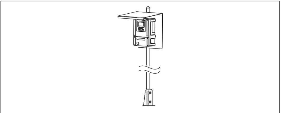
▣ 6 *Feldgerät an Halterung Flexdip CYH112 mit Wetterschutzdach*
