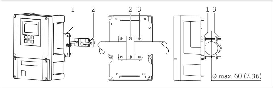
▣ 5 *Montage an horizontalen oder vertikalen Rohren*
