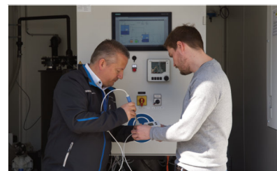
La calibration des électrodes pH s'effectue facilement à l'aide du mesureur portable CML18 grâce à la technologie Memosens.
