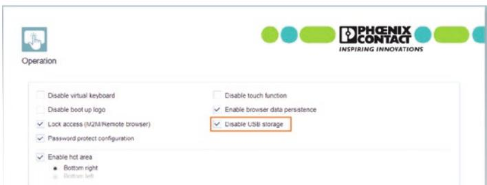
Die Einstellung wird durch Betätigen von **Übernehmen** gespeichert. Anschließend muss das Display durch Trennen der Spannungsversorgung neu gestartet werden.
