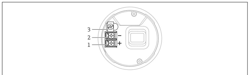
5 Os terminais de conexão e os terminais de terra no compartimento de conexão
