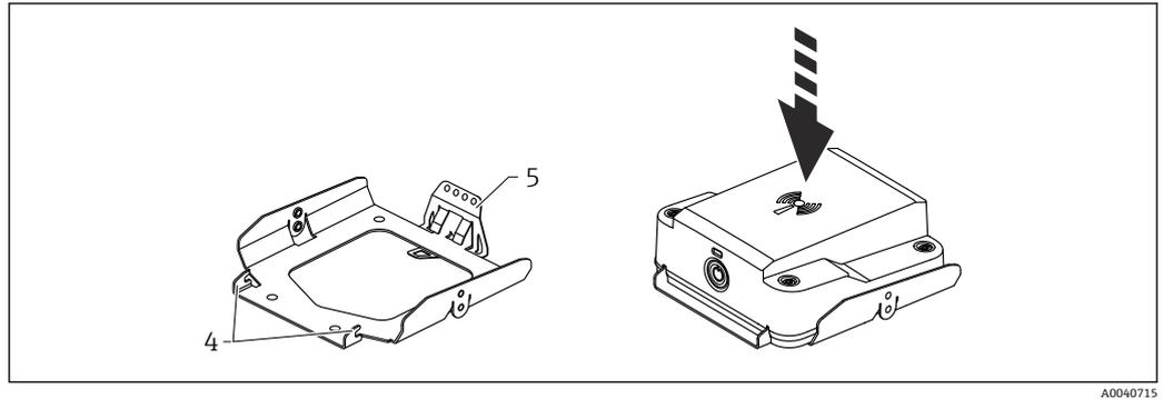
1. 通过卡扣 (4) 和弹簧 (5) 将 FWR30 固定在安装底座上。
