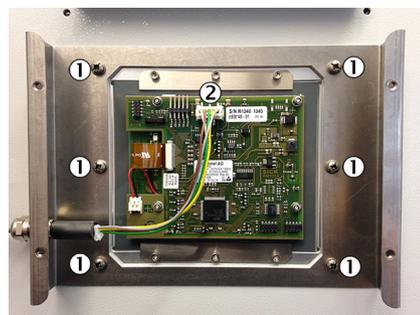
Abbildung 96: Display Befestigung
