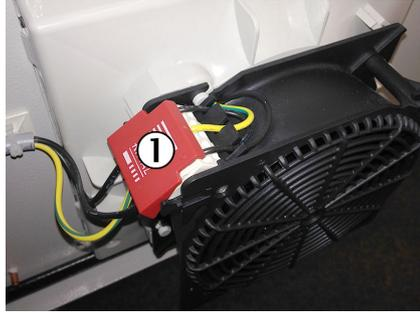
Abbildung 74: Abdeckung Spannungsversorgung Lüfter
