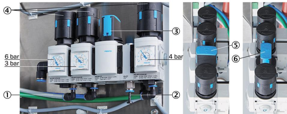
Abbildung 54: Druckminderer-Einheit
