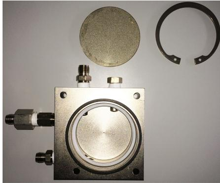
Abbildung 56: Filter mit Dichtung
