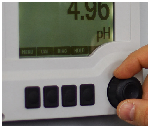
图 38 通过选配的外接显示单元操作
