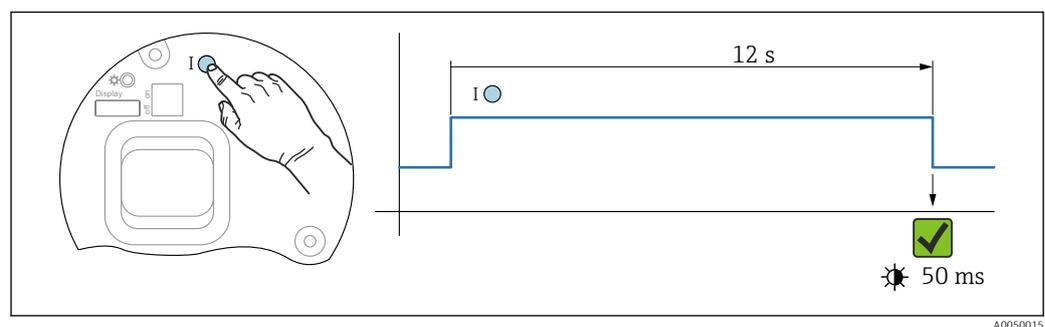
Fig. 12 Sequência para fazer um reset para as configurações de fábrica
