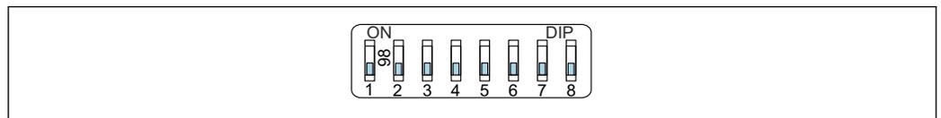
9 Exemplo de endereçamento de software: a seletora 8 é colocada na posição "OFF"; o endereço é definido no menu de operação
