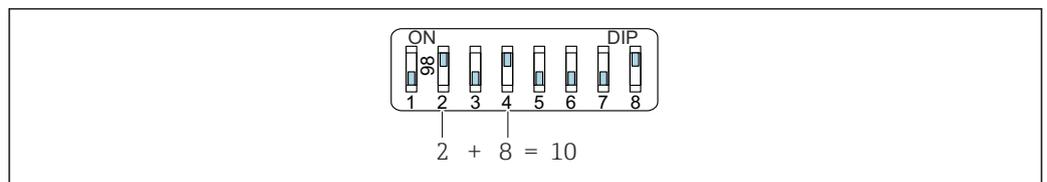
10 Exemplo de endereçamento de hardware: a seletora 8 é definida na posição "ON"; as seletoras 1 a 7 definem o endereço.
