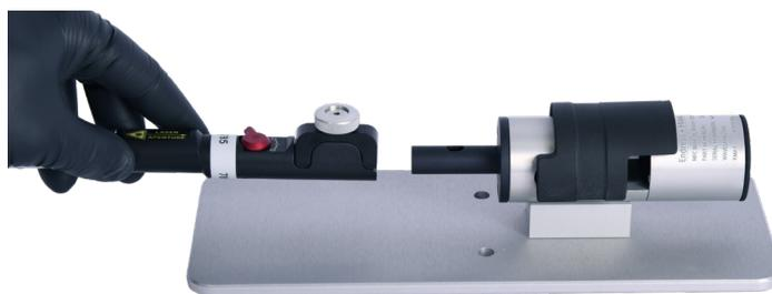
Rxn-10 プローブとマイクロフローベンチの接続
