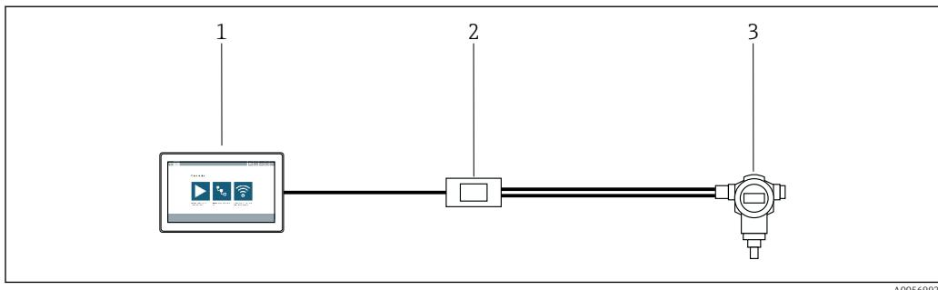
■ 2 Connexion point-à-point avec un appareil de terrain HART
