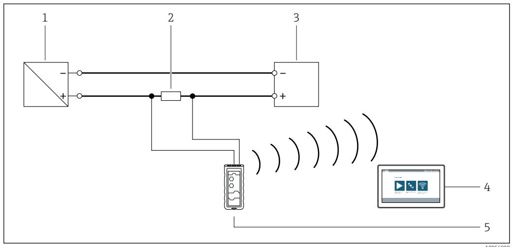
图 4 Connexion point-à-point via FieldXpert SFP50
