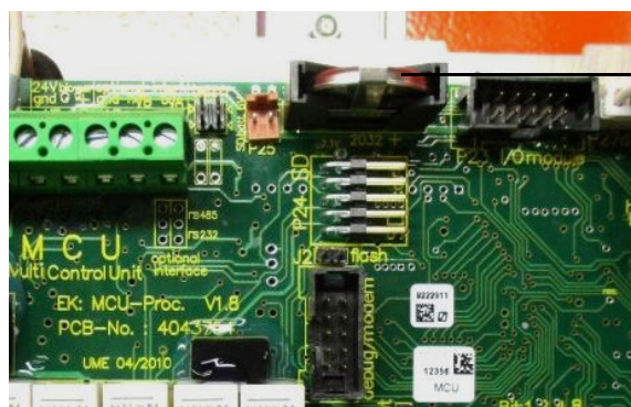
图 53: 更换 MCU 的钮扣电池
